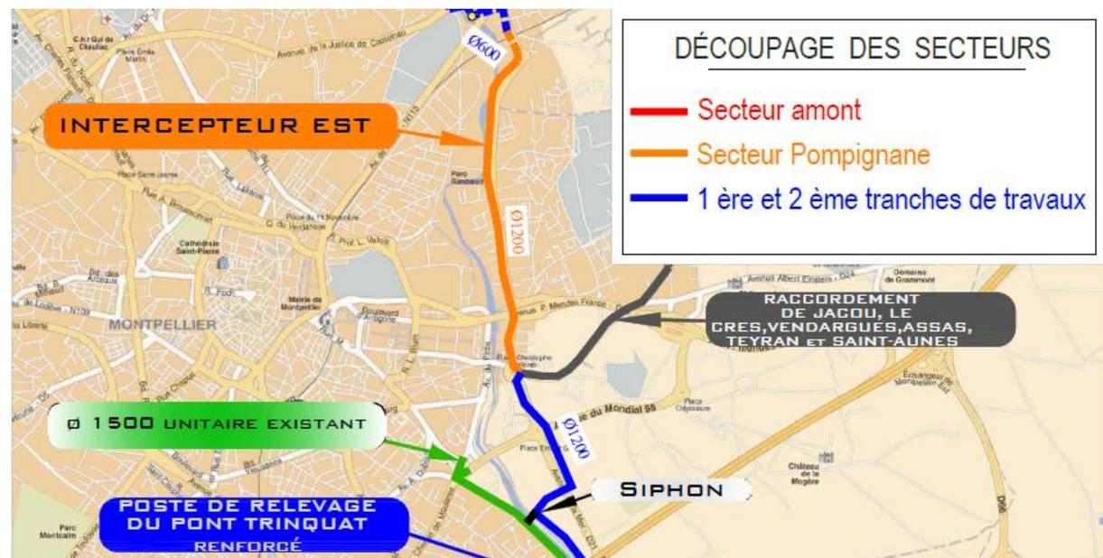
→ Pose de 2200 ml de canalisation en Béton diamètre 1200 mm par la technique du microtunnelier sous l'avenue de la Pompignane et réalisation d'un siphon en traversée du lez à proximité du pont André Levy
