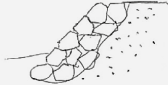
Mise en place avec surface extérieure des blocs parallèle à la pente général
