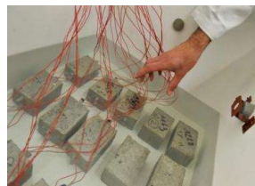
Essais de résistance à la pénétration de chlorures
